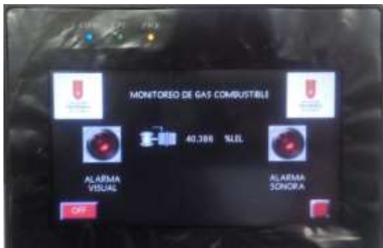
Figura 3 Interfaz de usuario touch screen marca REDLION mostrando la pantalla de visualización
