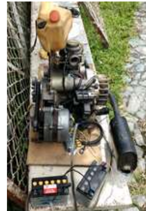
Figura 7 Prueba de la carga de las baterías utilizando el motor de combustión interna
