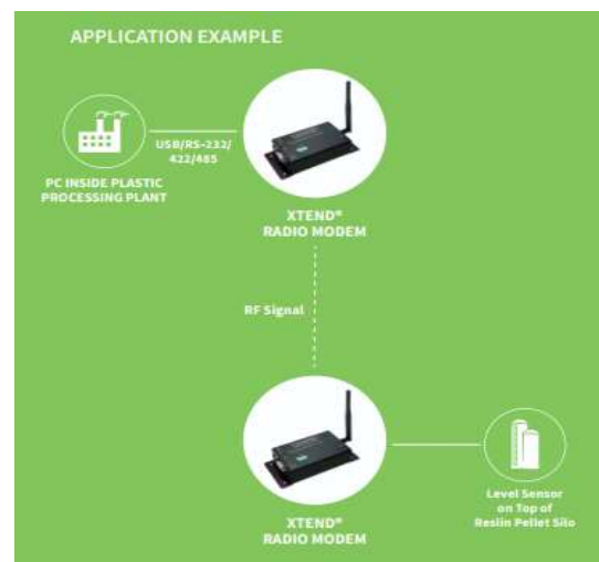
Figura 4 Ejemplo de aplicación del radio de comunicación de datos marca DIGI
