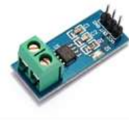
Figura 4 Sensor de corriente modelo ACS-712 Interfaz con ROS
