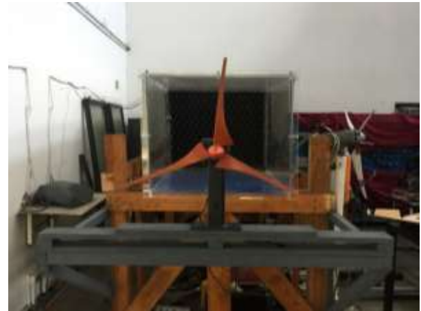
Figura 8 Turbina de 50 W, fabricada en material PLA mediante impresión en 3D
