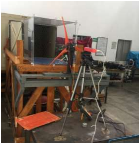
Figura 9 Equipos usados en las secuencias de arranque para obtener las magnitudes de los parámetros involucrados en el arranque
