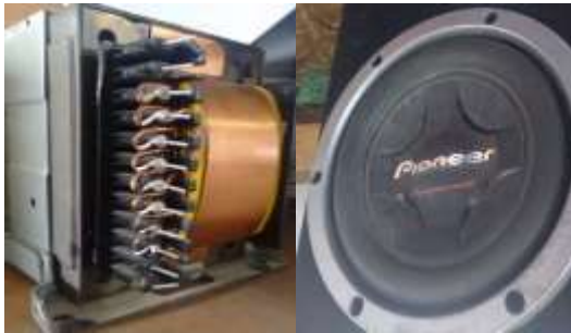
Figura 6 Transformador y altavoz de 600W
