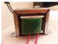
Figura 1 Transformador de tensión para acondicionamiento de la señal Fuente: (Illescas et al, 2015)
