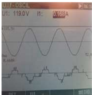
Figura 21 Señales de tensión y corriente vistas en el Metrel, carga capacitiva
