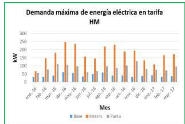
Gráfico 5 Demanda máxima de energía eléctrica en la Facultad de Ingeniería Fuente: Elaboración propia
