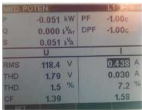
Figura 28 Medición carga resistiva Metrel
