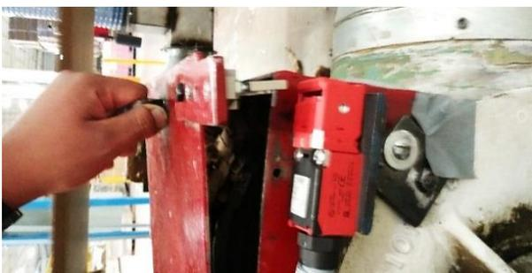
**Figura 7** Instalación de sensor Interruptor de límite
