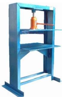
**Figura 25** Prensa hidráulica manual Modelo 70/80, con bases de 700 mm x 800 mm, espesor de 3/8", plancha de 700 mm x 800 mm. Placa de 1/2" con gato hidráulico de 10 ton presión
