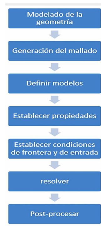
Figura 2 Pasos para la simulación en CFD Fuente: elaboración propia
