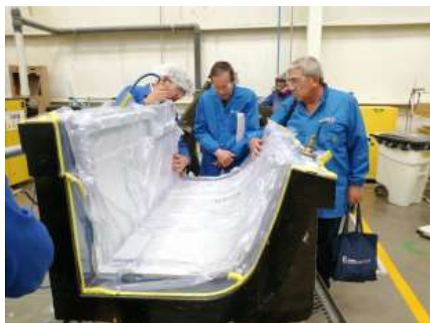
Figura 1 Molde para fabricación de asientos de avión
