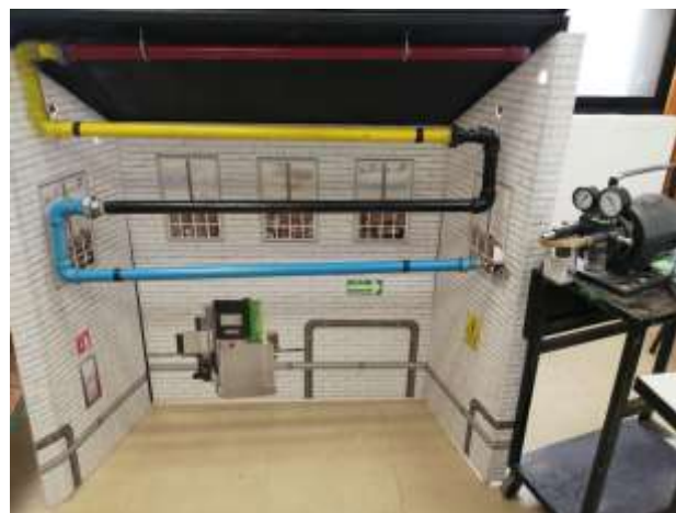
Figura 4 Sistema de tuberías desarrollado
