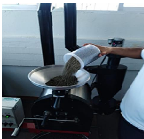
Figura 23 Vaciado de grano de café verde Fuente: Laboratorio de Ingeniería Industrial de la Universidad Veracruzana
