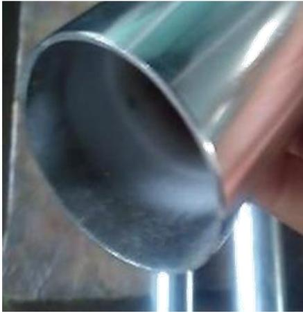
**Figura 3** Fallo en el electro-pulido interno de las piezas
