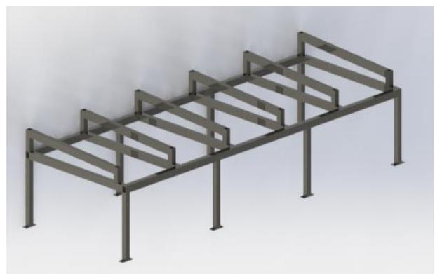
**Figura 5** Estructura de colocación de tubería
