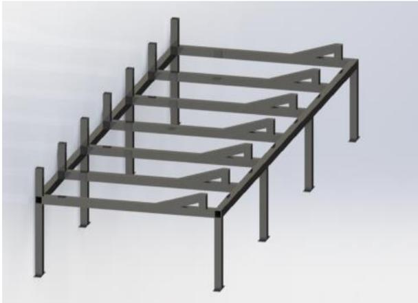
**Figura 6** Estructura de retiro de tubería
