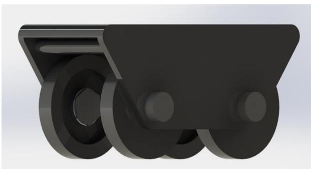
**Figura 8** Carro del brazo para cilindros
