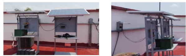
Figura 1 Sistemas fotovoltaicos montados a diferente ángulo de inclinación (0° y 20°)
