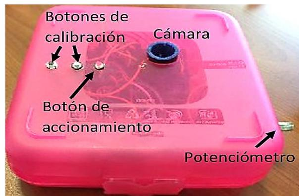
**Figura 7** Prototipo de colorímetro encapsulado
