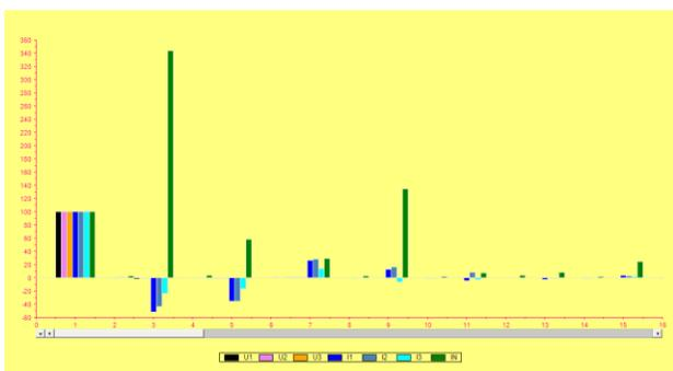
**Figura 46** Espectro de frecuencias del sistema eléctrico con el SFV conectado a él
