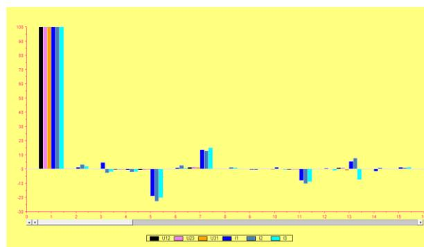
**Figura 34** Espectro de frecuencias inversor trifásico
