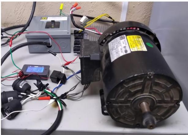
**Figura 18** Conexión de un motor trifásico al suministro de energía con el microinversor interconectado a la red.
