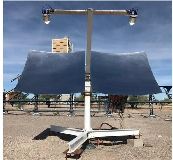
**Figura 1** Sistema de alta concentración fotovoltaico
