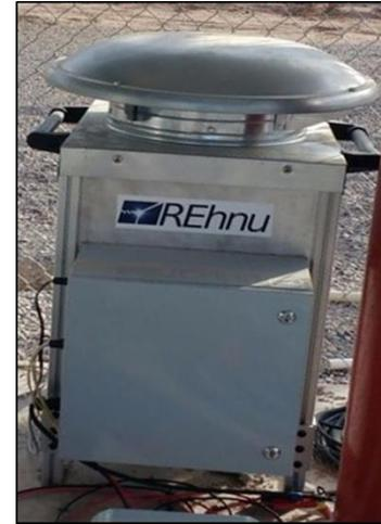
**Figura 3** Sistema automatizado de resistencia externa variable
