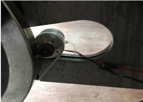
**Figura 2** Generador de 24v-36v
