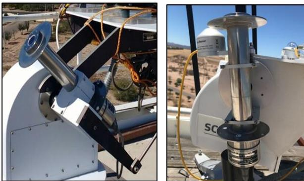
**Figura 2** Pirheliómetro Eppley Modelo NIP serie 3560802K6
