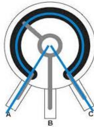
Figura 14 Representación esquemática del giro de un potenciómetro
