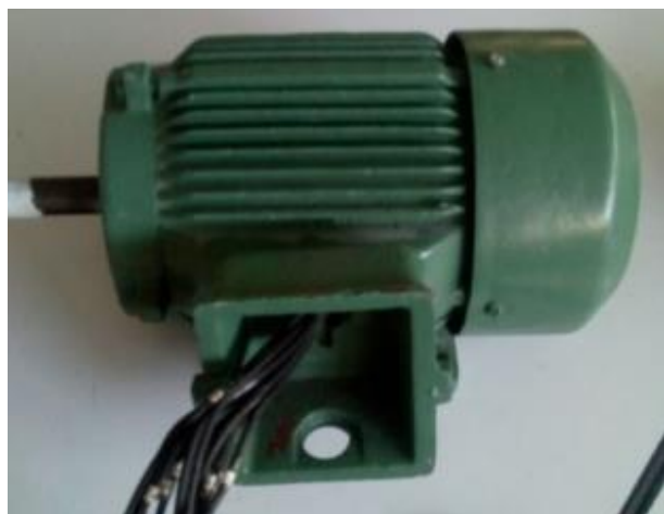
Figura 14 Motor trifásico de 1KW de 12 terminales Fuente: Fuente Propia
