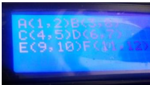
Figura 15 Resultado obtenido de las pruebas en un motor 12 terminales Fuente: Fuente Propia
