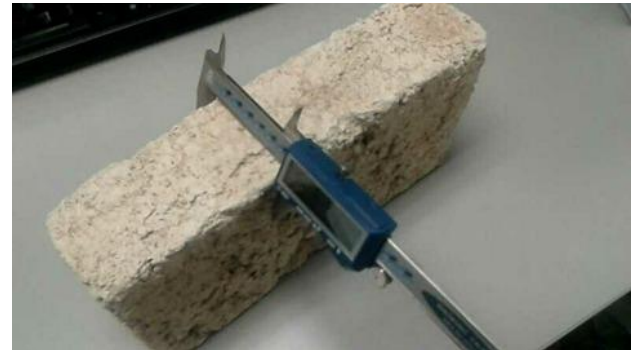
Figura 2 Medición de tabique térmico
