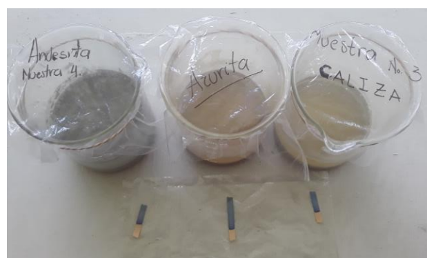
Figura 5 Prueba del Ph de las mezclas
