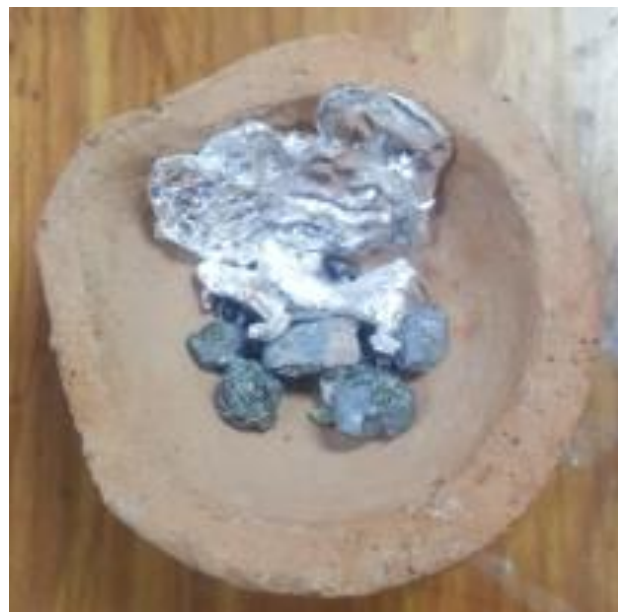
Figura 7 Resultado de la fundición del concentrado I
