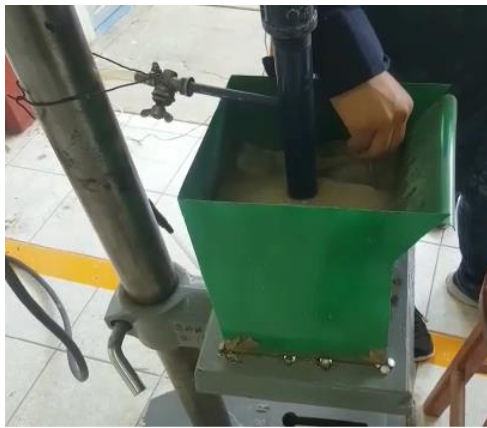
Figura 13 Prueba de pH en la celda de Flotación
