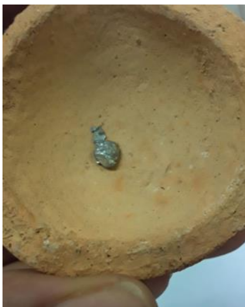
Figura 14 Botón de plata obtenido de la flotación
