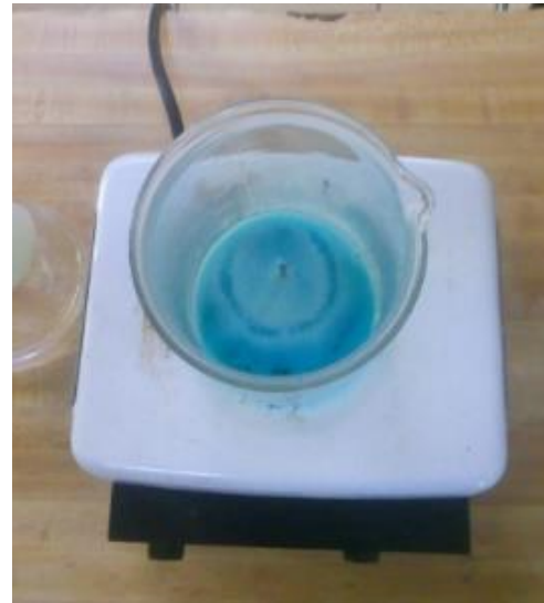
Figura 12 Reacción de plata con cobre
