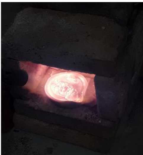
Figura 8 Fundición de muestra andesita
