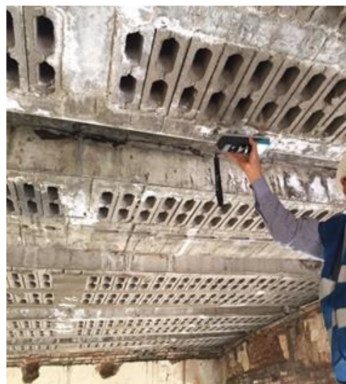
Figura 8 Estimación de la cuantía y ubicación del acero con pacómetro digital Marca Profoscope®
