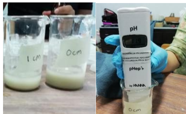
Figura 10 Pruebas de medición del pH por medio de potenciómetro digital Marca Hanna®
