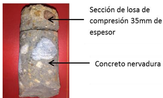
Figura 11 Núcleo de concreto y sección de la losa de compresión
