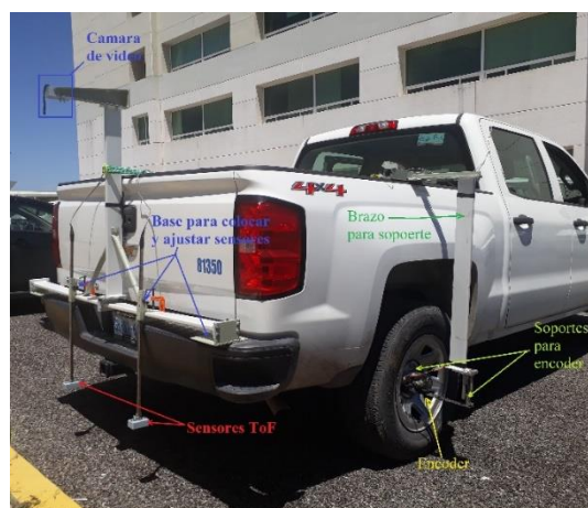
Figura 6 Configuración del sistema montado en el vehículo de prueba
