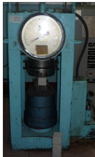
Figura 7 Ensayo de especímenes para la determinación de la Resistencia a compresion
