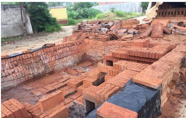
Figura 3 Piezas de tabique rojo recocido en el horno
