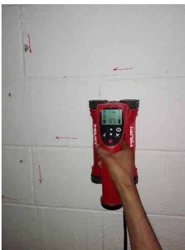
**Figura 3** Prueba para detectar acero de refuerzo en edificios revisados
