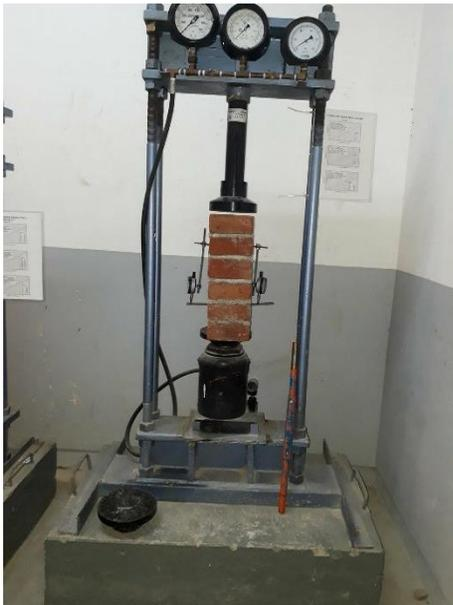
Figura 7 Ensayo a compresión de pila de mampostería
