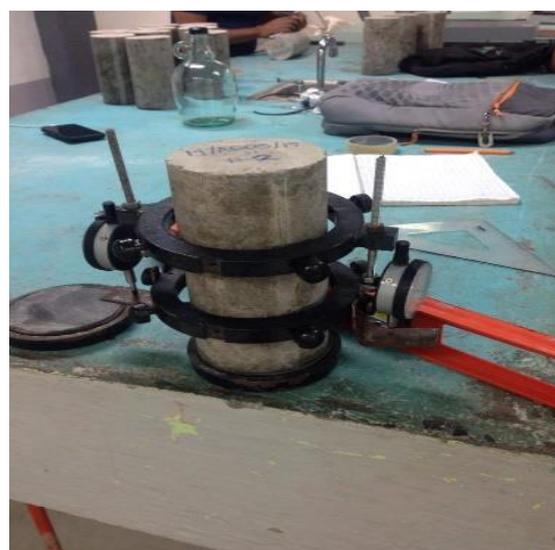
**Figura 4** Aplicación de carga axial y lectura de deformación
