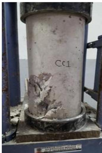
**Figura 8** Ensayo a compresión axial de cilindros de concreto simple
