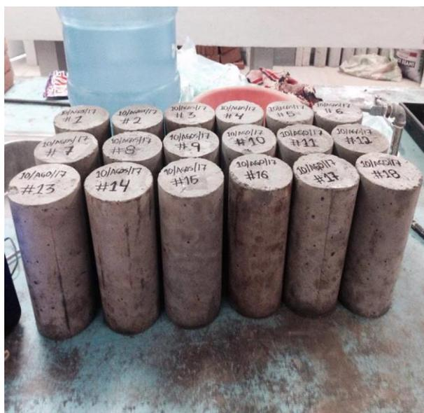
**Figura 2** Cilindros de concreto listos para que se realicen las pruebas correspondientes
