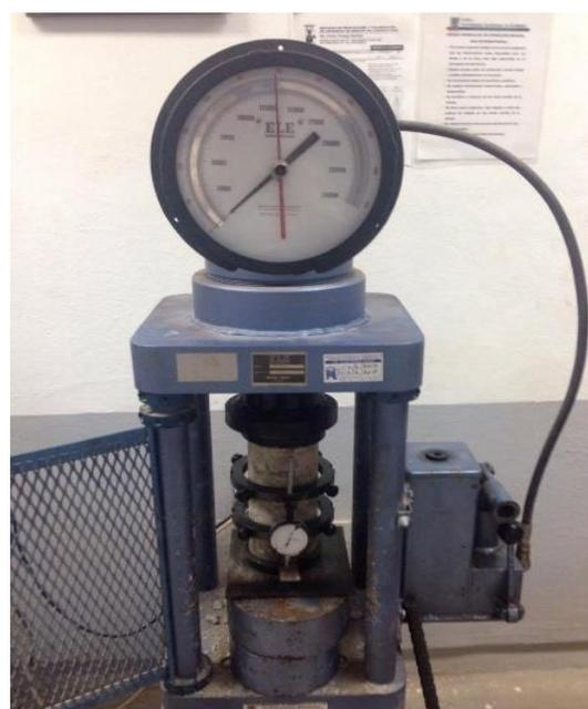
**Figura 3** Preparación del cilindro de concreto con anillos y micrómetros para medir la deformación
