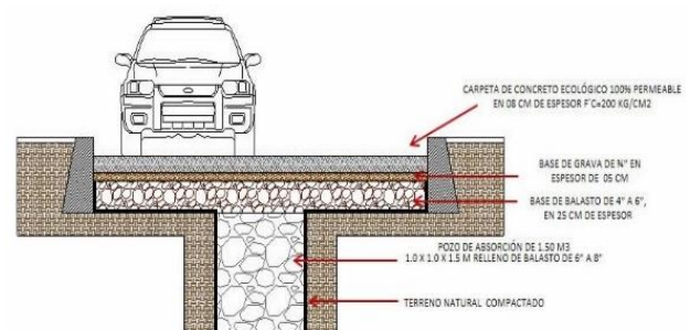
Figura 2 Estructura de pavimento permeable.
