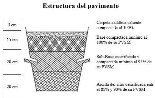
Figura 7 Estructura del pavimento
