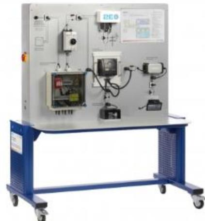
**Figura 1.8** Módulo ET 255 Aprovechamiento fotovoltaico: en paralelo a la red o en isla. (GUNT)
