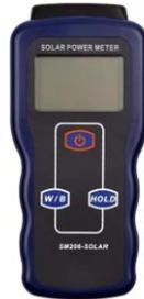
**Figura 6** Solarímetro
