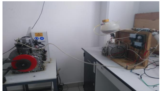
Figura 14 Motor MERLIN2 alimentado con la producción de hidrógeno de celdas secas en conexión paralela Fuente: Elaboración Propia
