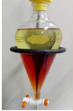
Figura 2 Productos obtenidos, biodiésel en la parte superior y glicerina de color marrón en la parte inferior Fuente: Elaboración Propia
