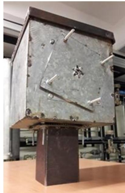
**Imagen 5** Fotografía del seguidor que se construyó para el proyecto. Con dos grados de libertad de movimiento
