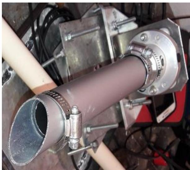
**Imagen 13** Fotografía del detalle de la cubierta protectora del pirheliómetro
