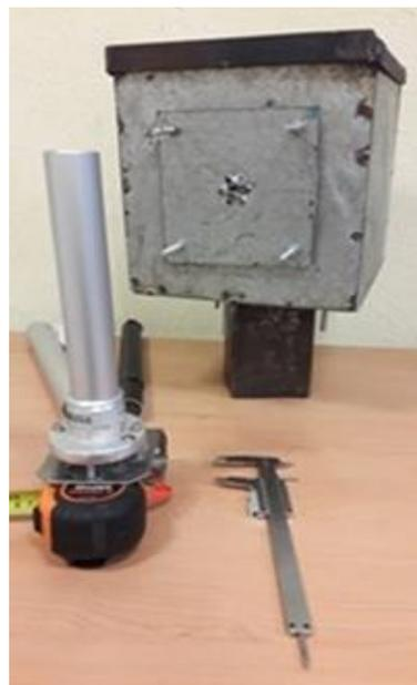
**Imagen 10** Fotografía del Piranómetro con los 2 tubos de aluminio y el seguidor al fondo
