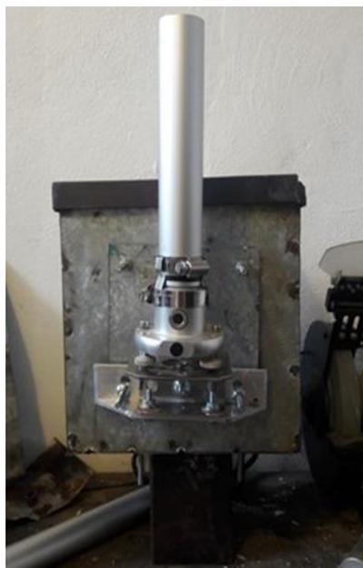
**Imagen 12** Fotografía del Pirheliómetro montado en el seguidor solar
