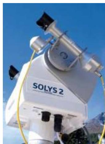
**Imagen 7** Pirheliómetro montado en un seguidor solar
