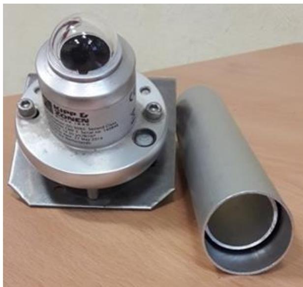
**Imagen 9** Fotografía del Piranómetro con su domo y los 2 tubos de aluminio cortados de acuerdo a las medidas de la figura 5
