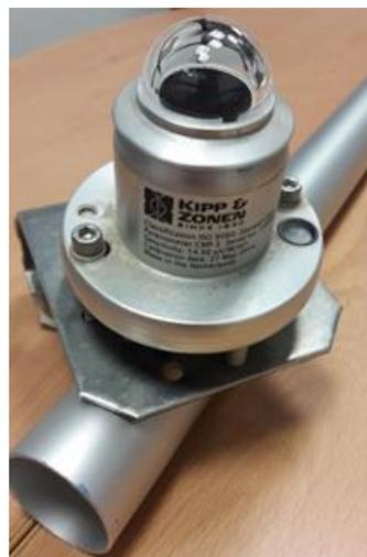
**Imagen 8** Fotografía del Piranómetro CMP3 donde puede verse el domo de 32 mm, el elemento sensor oscuro de 25.4 mm (1") y el tubo de 38 mm
