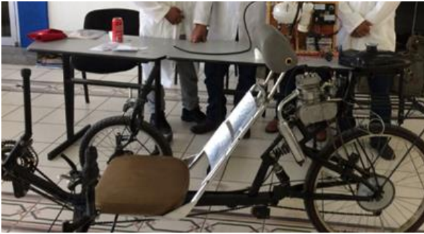
Figura 7 motor de combustión interna con celda de hidrógeno
