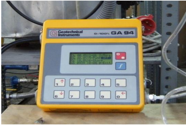
Figura 2 Equipo de medición de gases modelo Geotechnical Instruments GA94A
