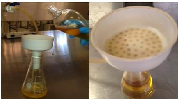
**Figura 5** Filtrado de biodiesel
