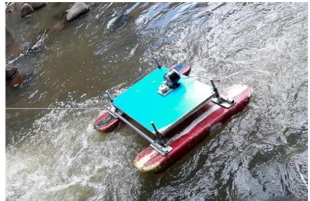
**Figura 6** Desarrollo de pruebas de generación y almacenaje de energía en campo real del prototipo de generación de energía de la central mini-hidroeléctrica portátil desarrollada por el equipo de CIPLL del SENA regional Nariño
