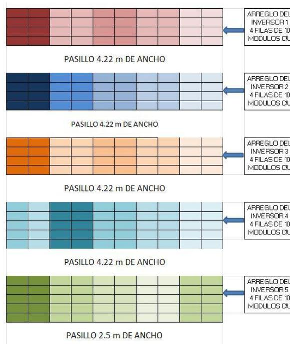
**Figura 9** Configuración general del sistema fotovoltaico
