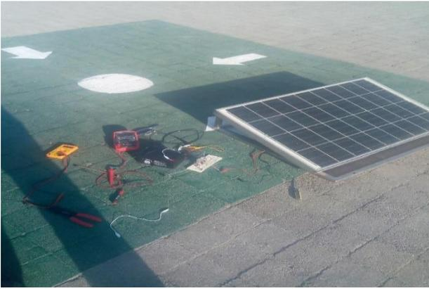
**Figura 5** Conexión del panel fotovoltaico al controlador de carga
