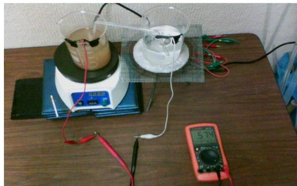
**Figura 1** Prototipo de celda eléctrica con extracto de clorofila y una solución de ZnCl<sub>2</sub>
