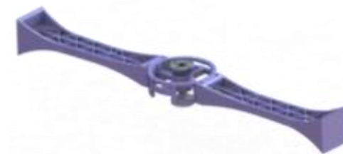
Figura 2 Estructura central VANT coaxial.
