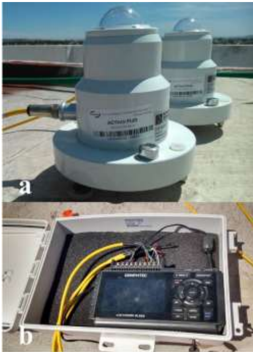
Figura 2 Sistema de muestreo a) radiómetros Kipp & Zonen UV-S-A-T y UV-S-B-T y b) adquisidor de datos Graphtec GL220
