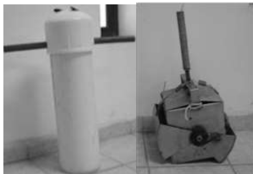
Figura 4 Técnicas de muestreo de sedimentos superficiales: Nucleador y Draga
