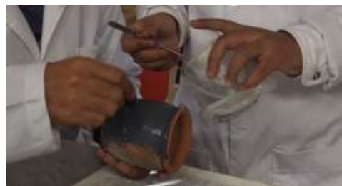
Figura 6 Celda de combustible recubierta con la mezcla de aglutinante con carbón activado y grafito
