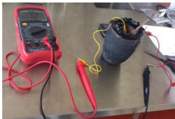
Figura 7 Mediciones de voltaje eléctrico en la celda de combustible microbiana en las muestras de sedimentos
