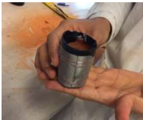
Figura 5 Celda de combustible, armada con recipiente de arcilla y recubierta con malla de acero inoxidable y cobre
