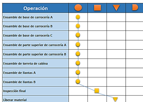
Figura 5 Diagrama de flujo del ensamble del carro Fuente: elaboración realizada por los alumnos de Procesos Industriales
