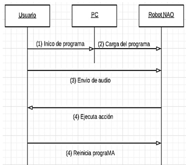
Figura 3 Diagrama de secuencias procesamiento de audio y ejecución de acciones mecánicas
