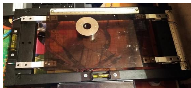
Figura 5 Prueba con una distancia de 8 cm y 4 cm con una fuerza de 2N
