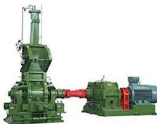
Figura 14 Molino al que se le aplicó el Overhaul completo, con su reductor de velocidad y su motor eléctrico de 200 HP. En nave #1
