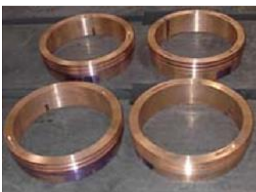
Figura 12 Anillos de bronce bipartidos para los rodillos remanufacturados Nave #1
