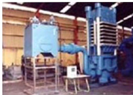
Figura 13 Prensa para vulcanizar hule que funciona con vapor de una caldera, área de ensamble nave #1
