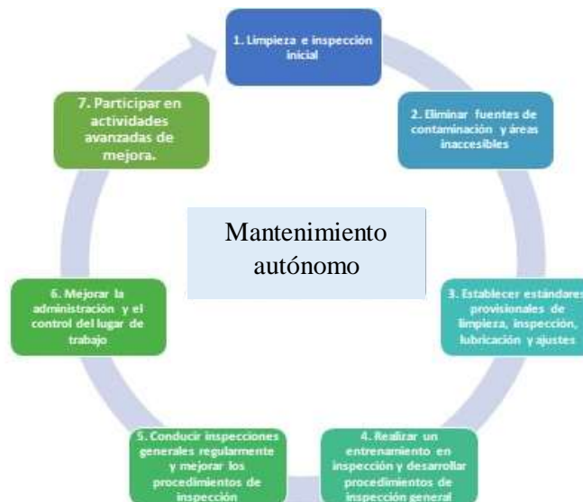
Figura 1 Metodología para la implementación del mantenimiento autónomo
