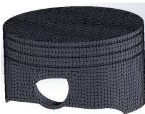
Figura 10 Mallado para análisis por elemento finito
