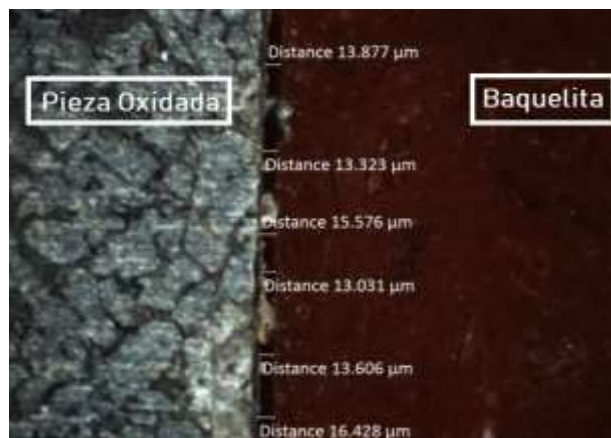
Figura 5 Espesores obtenidos de las pruebas de laboratorio
