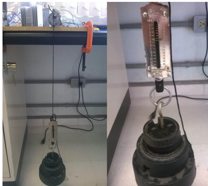
Figura 3.7 Carga colocada en el eje, colgando de un dinamómetro para su medición
