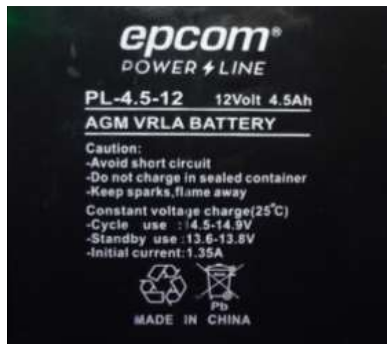
Figura 178 Batería Epcom® de 12v a 4.5Ah
