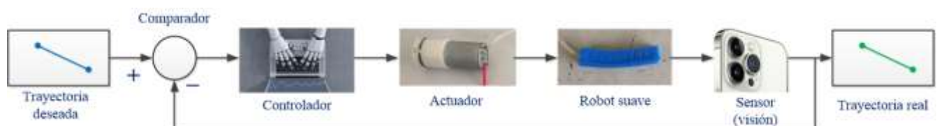
Figura 5.1. Diagrama de bloques para el control del robot suave
