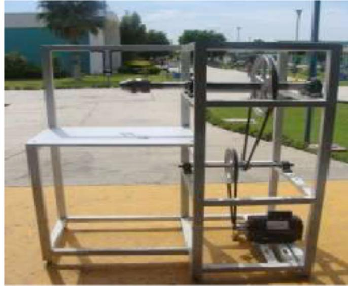
Alternativa 1: Estructura conformada únicamente por PTR estructural de 2" x 2" x 3/16". Se planteo así debido a detalles constructivos, espesores de chumaceras y por datos tomados de un equipo similar ya construido y que está en operación en una fábrica familiar. El peso de este chasis es de 70.94 kg.
