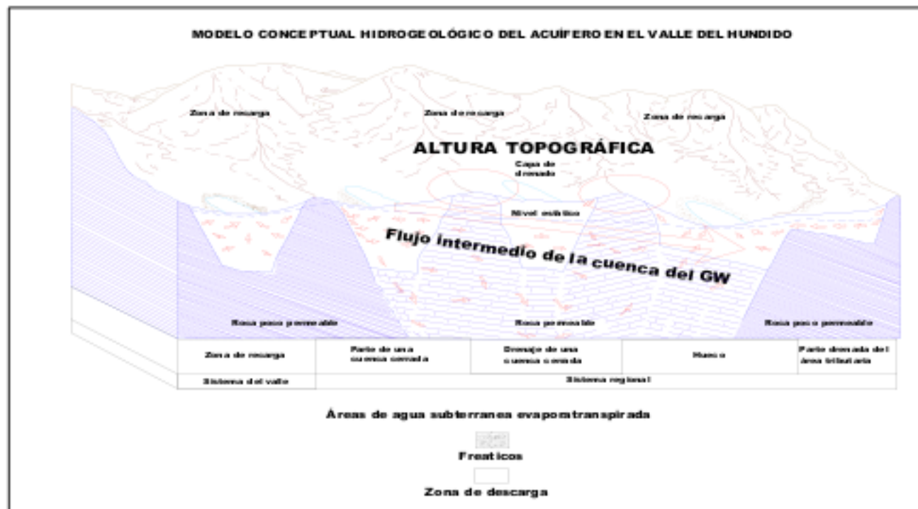
Figura 9.10 Modelo conceptual hidrogeológico del acuífero en el Valle el Hundido
