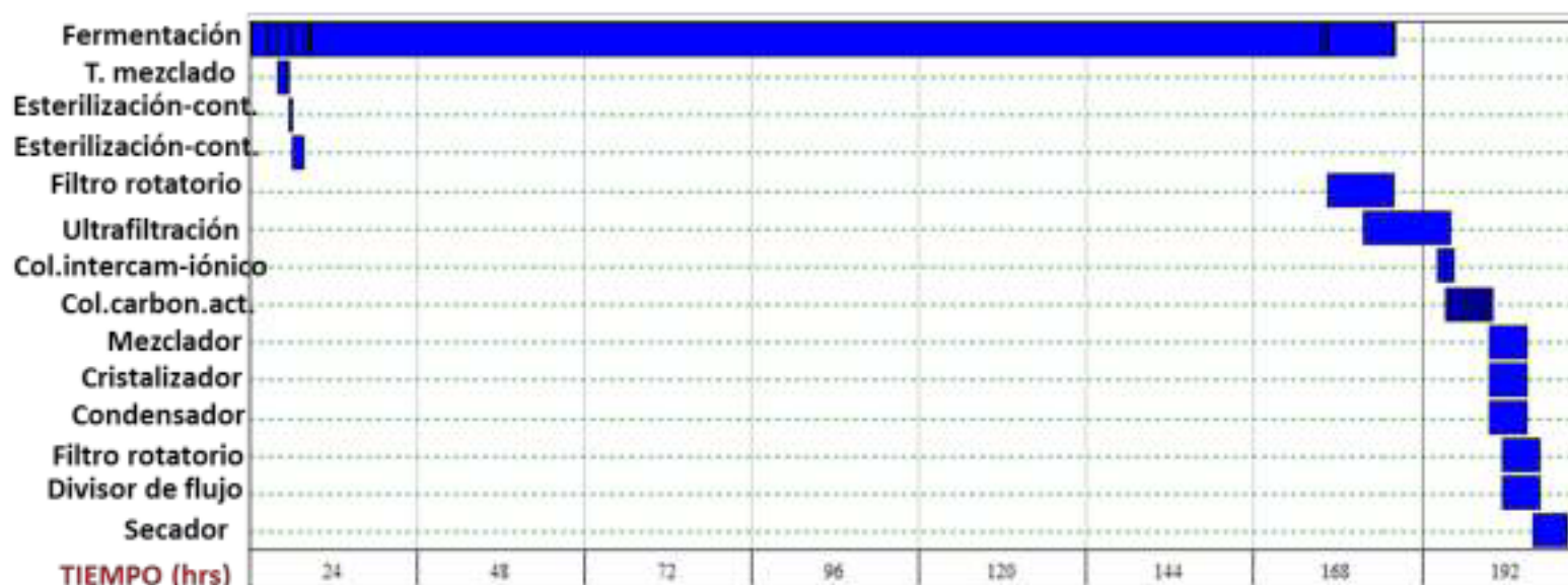
Grafico 12.5 Distribución del equipo de bioproceso de fermentación de ácido cítrico en SuperPro Designer , incluyendo Upstream y Downstream .
