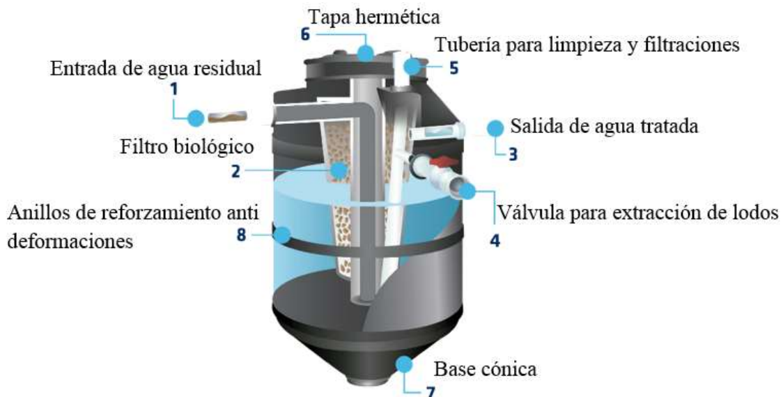
Figura 2 Biodigestor de base cónica
