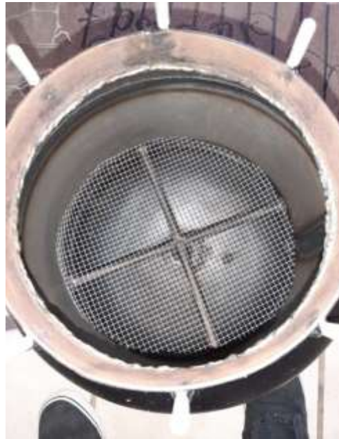
Figura 7 Preensamble del tanque-contenedor para el biodigestor
