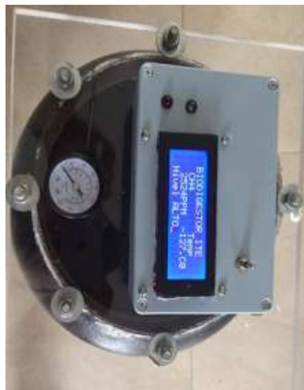
Figura 11 Vista superior del biodigestor ensamblado
