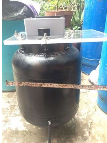
Figura 9 Vista lateral del biodigestor y verificación de diámetro
