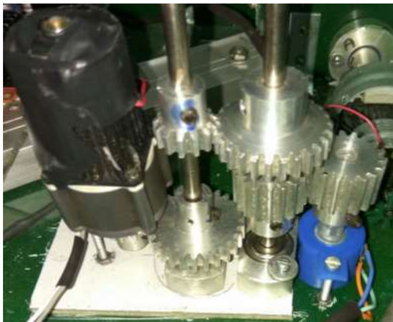
Figura 23 Transmisión montada en el chasis
