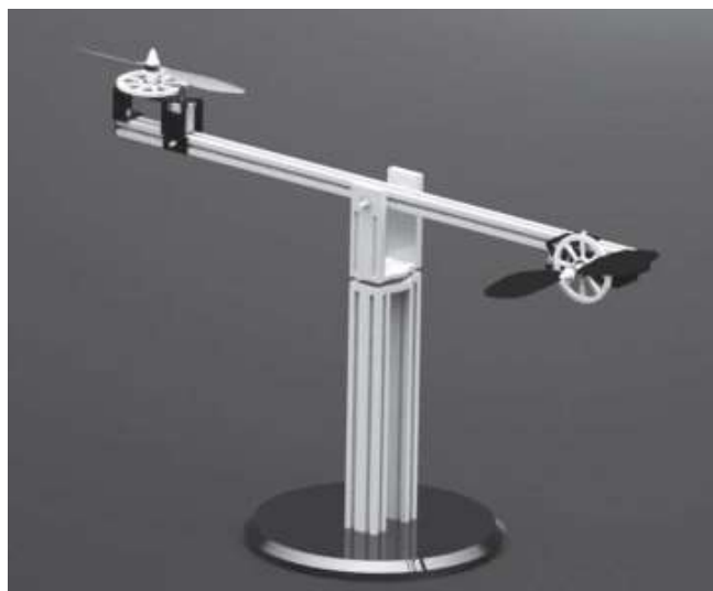
Figura 2 Plataforma experimental tipo helicóptero de un grado de libertad
