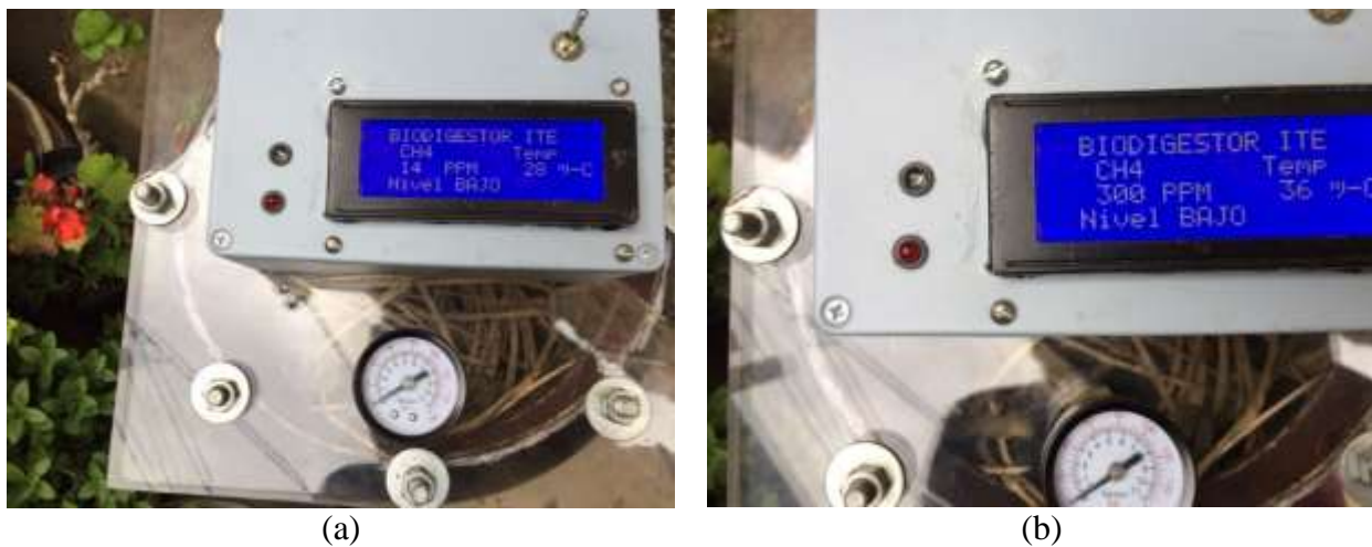
Figura 17 Lecturas registradas para la mezcla 3: (a) mínima, (b) máxima.
