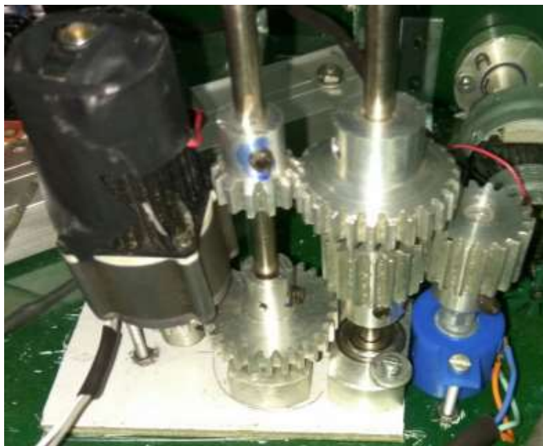
Figura 23 Transmisión montada en el chasis
