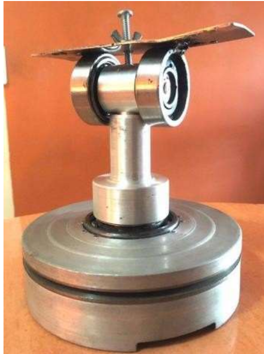
Figura 36 Base giratoria construida
