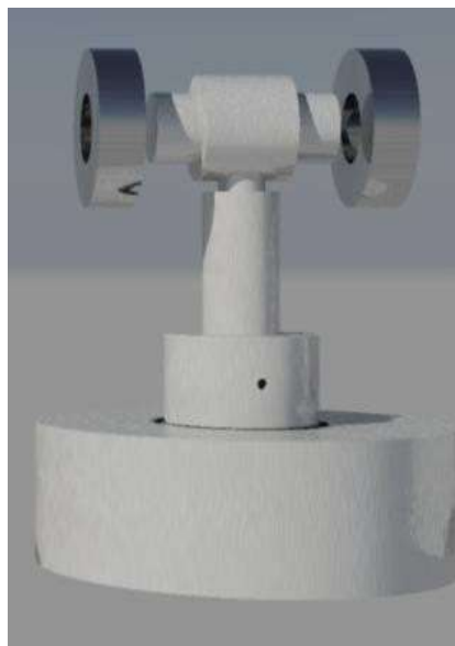
Figura 18 Ensamble de la base giratoria para el cabeceo
