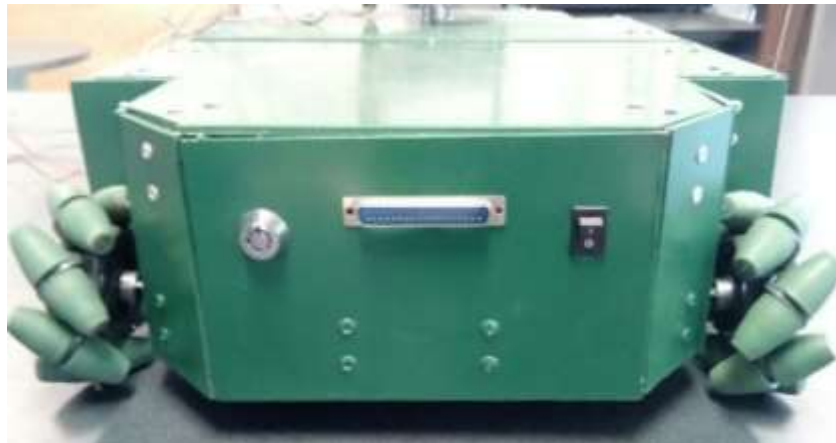
Figura 20 Tablero de la parte trasera del robot omnidireccional
