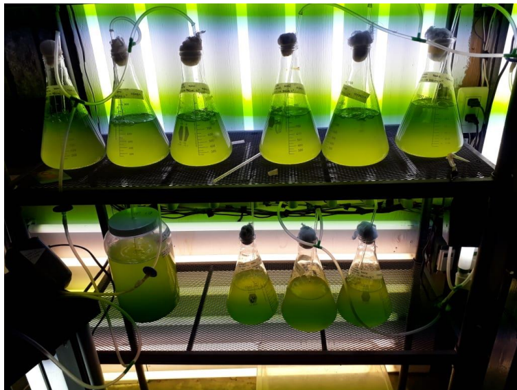
Figura 7.1 Fotorreactores utilizados para crecimiento de una cepa de la microalga Dunaliella tertiolecta
