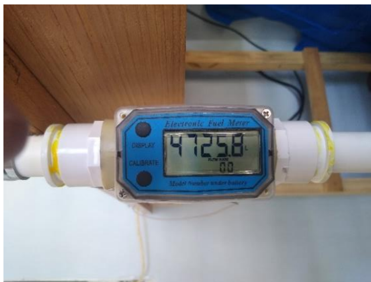
Figura 3.6 Medidor de flujo digital (patrón de referencia)
