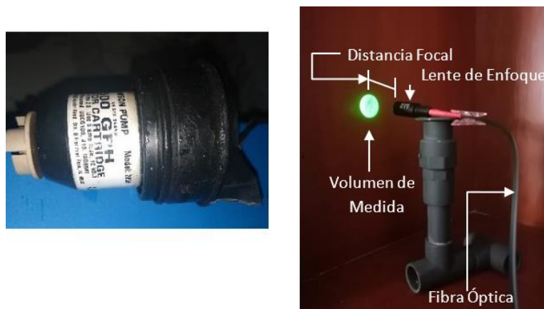
Figura 5.4 Volumen de Medida y Bomba sumergible Johnson 2855
