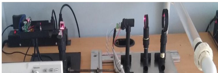
Figura 3.8 Arreglo óptico de prismas y lentes biconvexas
