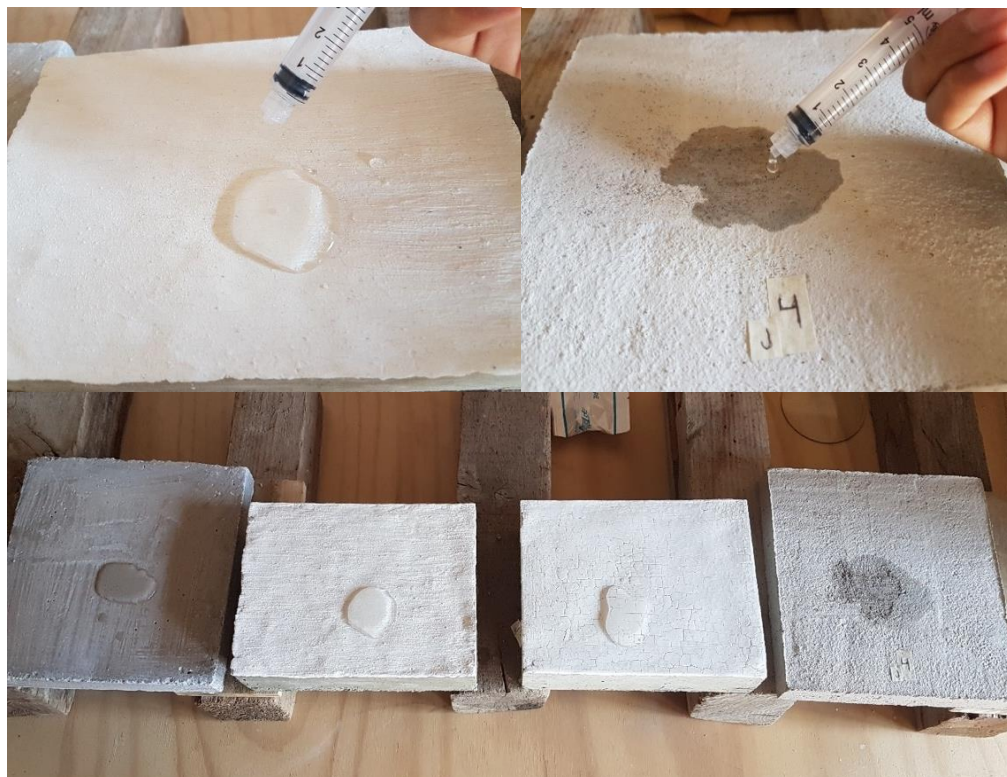
Figura 13 Monitoreo de filtración en probetas
