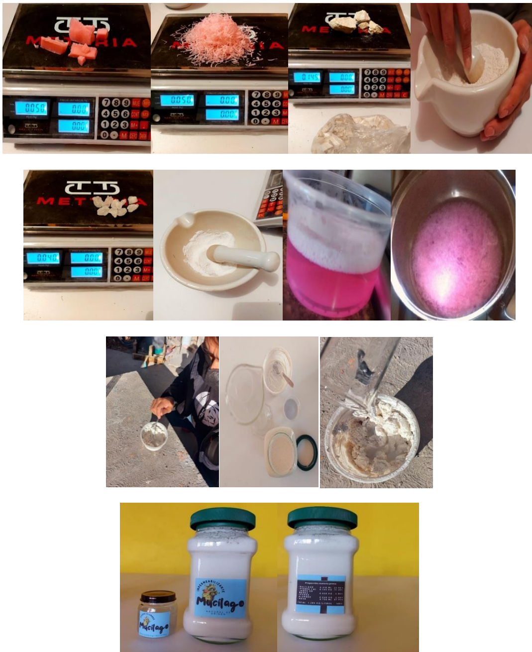
Figura 11 Proceso de elaboración del impermeabilizante a base de mucilago de nopal (Ver metodología de impermeabilizante a base de mucilago de nopal)
