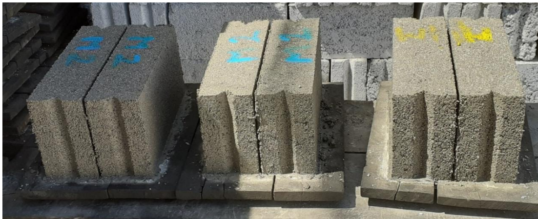
Figura 9 Bloques retirados de la máquina moldeadora marcadas por prototipo y situadas a la sombra
