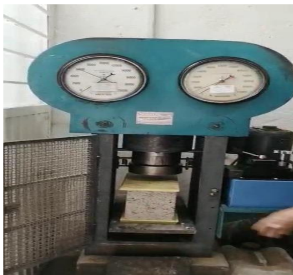
Figura 10 Realización de prueba a la compresión
