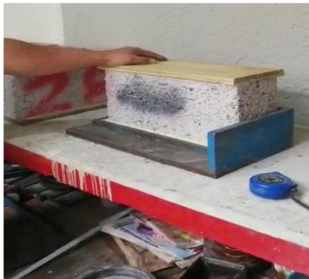
Figura 9 Cabeceo del block con sulfato
