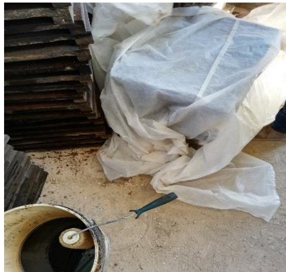
Figura 8 Cubierta de block para su secado natural a 7, 14 y 28 días
