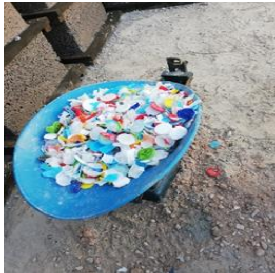
Figura 3 Obtención de la trituración de los taparrosas del PET
