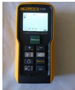
Figura 3 Distanciómetro utilizado para tomar distancias del edificio
